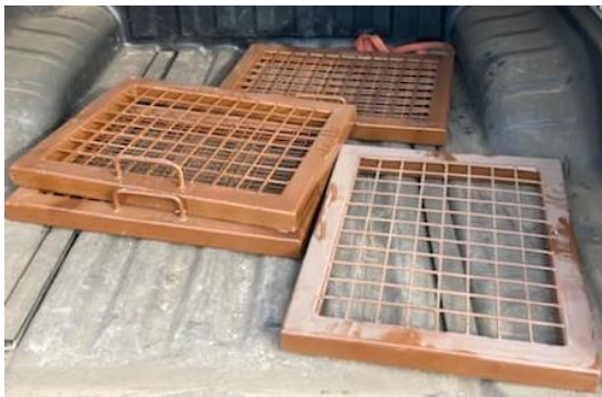
Obr. 21. Ukázka sít umístěných na vypouštěcí zařízení (požerák) Vysokopeckého rybníka v Bohutíně v roce 2020
